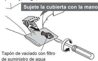
7. Vuelva a instalar el tapón de vaciado con filtro de suministro de agua y cierre la cubierta.
