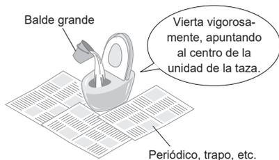
2. Si el nivel del agua es bajo tras la descarga, añada más agua. (Hasta que el nivel del agua no suba más.)
