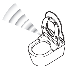
Capteur de présence B (Détecte la présence d'une personne à proximité)
