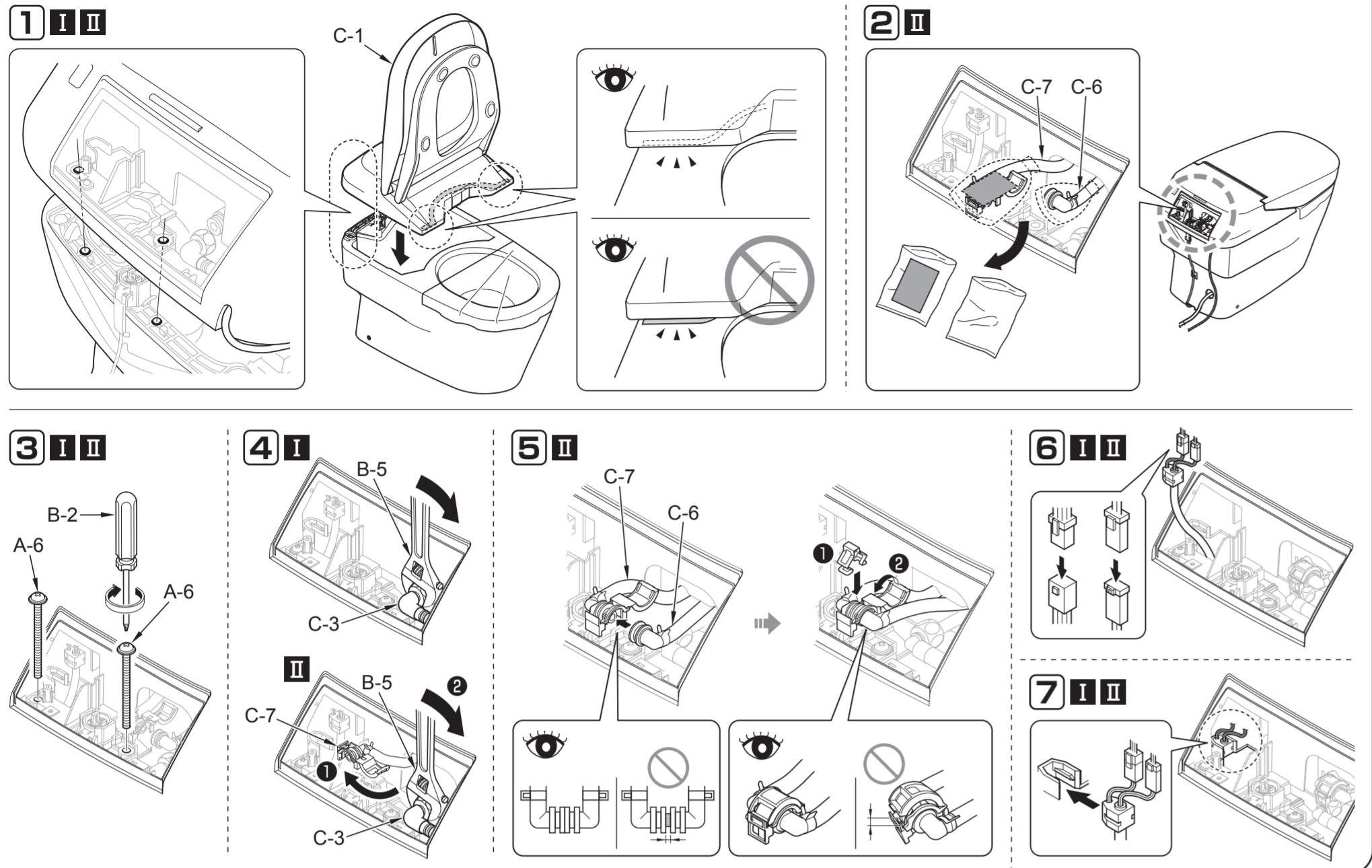
**I II** Remote control mounting / Montage de la commande à distance / Instalación del control remoto
