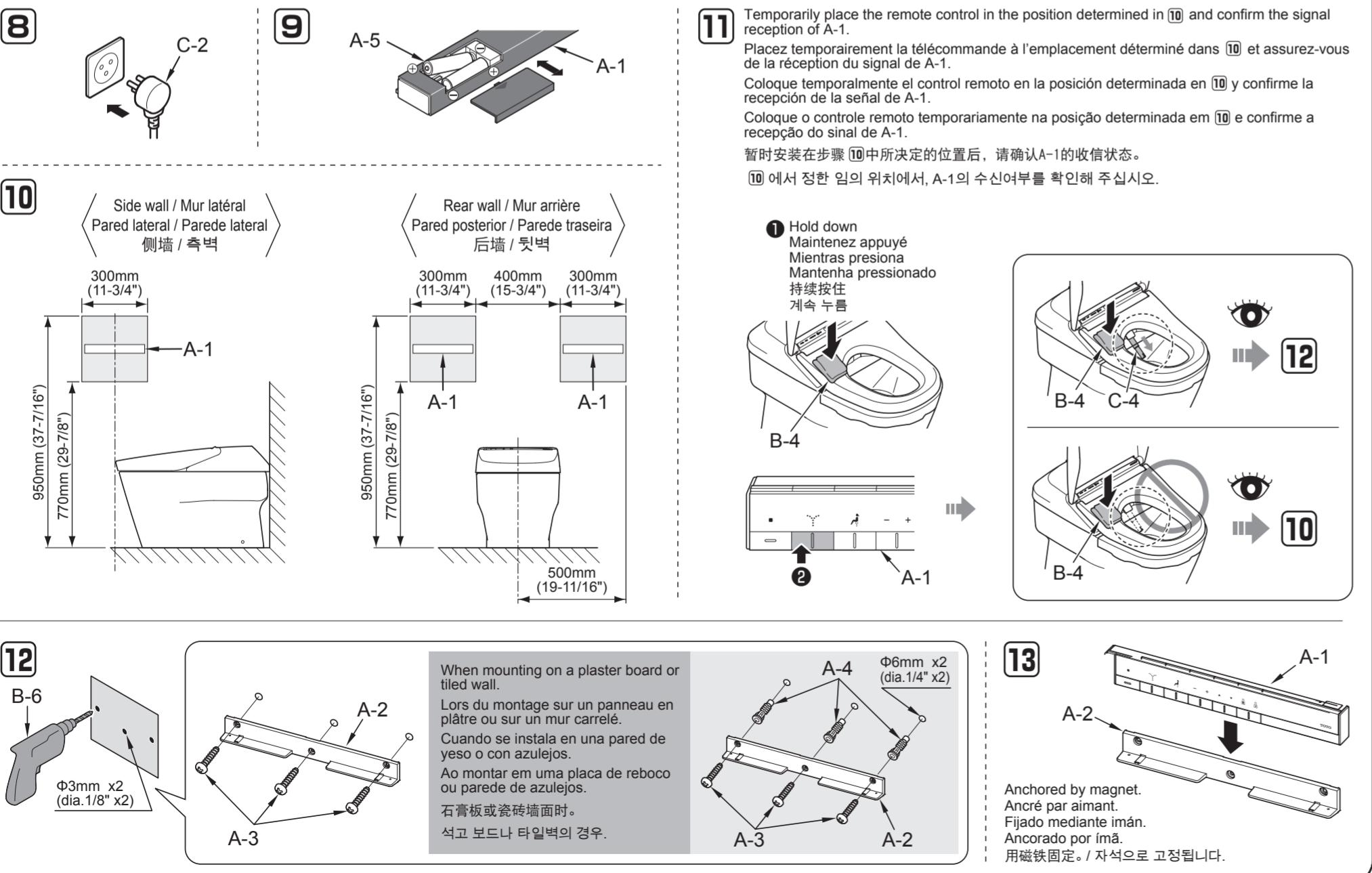
Trial run / Mise en service / Puesta en funcionamiento
